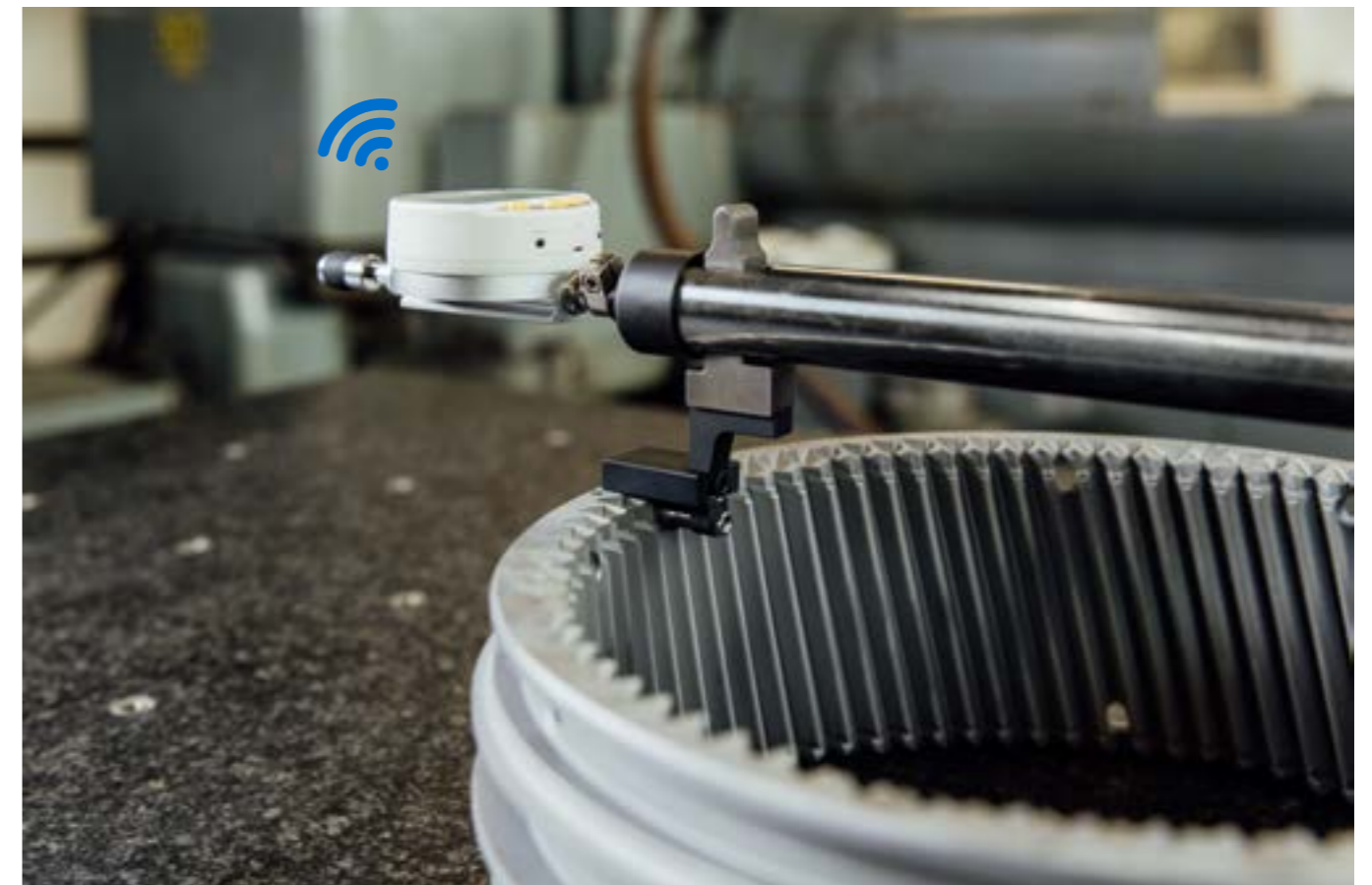
Mätning av kulmått på splines med anpassad stödplatta för korrekt mätdjup. Här med digital mätklocka med Bluetooth.
